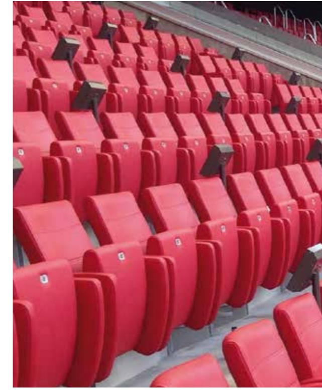
Exklusiver vollgepolsterter VIP-Sitz mit gepolsterten Seitenwangen. Traversenmontierter Klappstuhl mit ringsum gepolsterter Sitzfläche und Rückenlehne. Sitzträger aus Stahl kathodisch tauchlackiert (KTL) und pulverbeschichtet mit Epoxidharz. Lagerhebel und Drehlager aus verstärktem Polyamid mit Schlagzähmodifikatoren.
