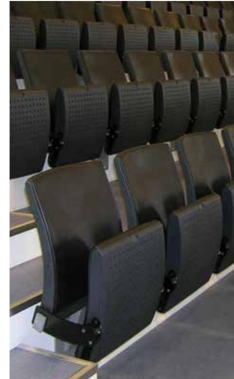
Erhöhte Rückenlehne (+100 mm) für mehr Komfort und Ästhetik. Traversenmontierter premium Klappstuhl mit auswechselbaren Polstereinlegern für Sitz und Rücken. Spritzgegossene Außenschalen aus Polypropylen mit Brand- und UV-Schutzadditiven. Optional mit akustischer Perforierung für den Innenbereich erhältlich. Sitzträger aus Stahl kathodisch tauchlackiert (KTL) und pulverbeschichtet mit Epoxidharz. Lagerhebel und Drehlager aus verstärktem Polyamid mit Schlagzähmodifikatoren.
