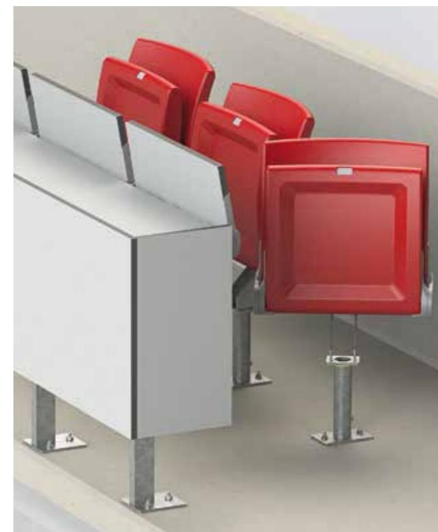
Das ringsum rotierende Drehgestell ermöglicht einen erweiterten Blickwinkel sowie erleichterten Zugang zu Presse- und Kommentatoren-Plätzen. Frei kombinierbar mit individuell angepassten Klappischen. Klappstuhl mit ergonomisch geformter Sitzfläche und Rückenlehne aus blasgeformtem Polypropylen mit Brand- und UV-Schutzadditiven. Sitzträger und Lagerhebel aus verstärktem Polyamid mit Schlagzähmodifikatoren.
