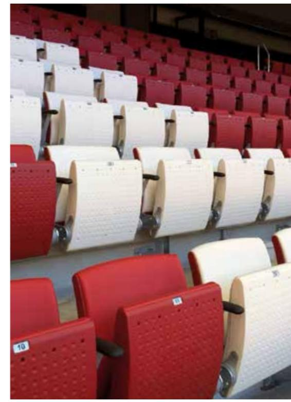
Traversenmontierter premium Klappsitz mit austauschbaren Polstereinlegern für Sitz und Rücken. Spritzgegossene Außenschalen aus Polypropylen mit Brand- und UV-Schutzadditiven. Optional mit akustischer Perforierung für den Innenbereich erhältlich. Sitzträger aus Stahl kathodisch tauchlackiert (KTL) und pulverbeschichtet mit Epoxidharz. Lagerhebel und Drehlager aus verstärktem Polyamid mit Schlagzähmodifikatoren.
