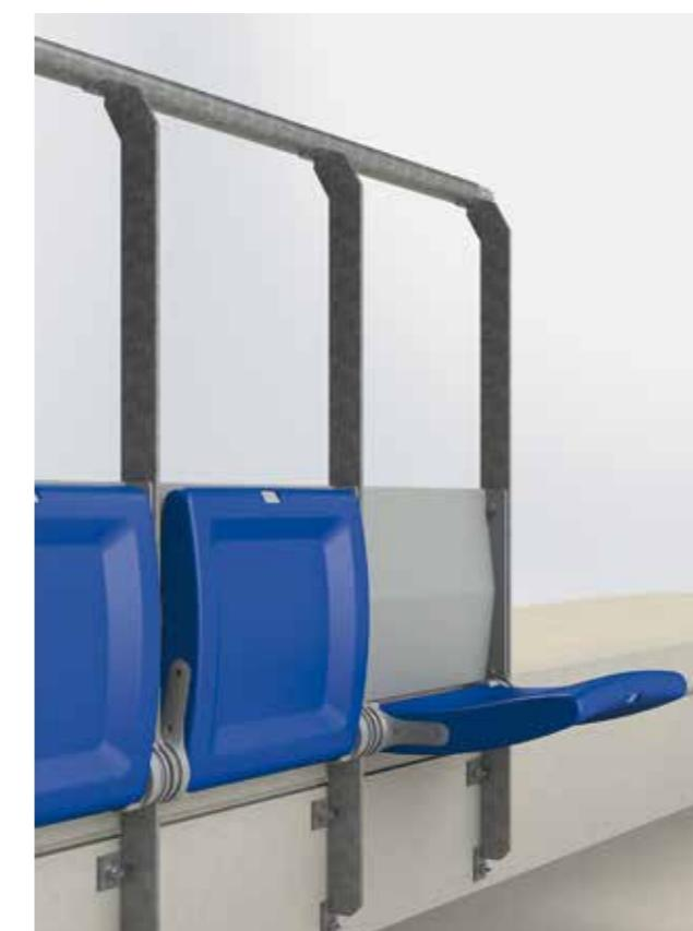
Hybrider Klappstuhl im ARC-Design für sicheres Stehen und bequemes Sitzen unter begrenzten Platzverhältnissen. Die Rückenlehne, die Standsäulen und der Handlauf aus hochwertigem Stahl sorgen sowohl für Robustheit als auch für eine optimale Raumnutzung. Ergonomisch geformte Sitzfläche aus blasgeformtem Polypropylen mit Brand- und UV-Schutzadditiven. Lagerhebel und Drehlager aus verstärktem Polyamid mit Schlagzähmodifikatoren.
