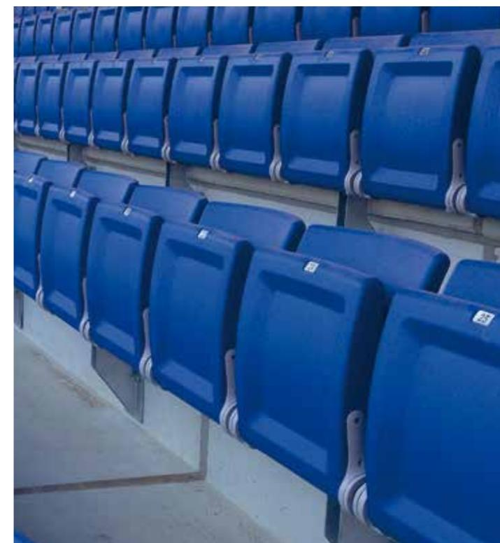
Basismodell und Bestseller der ARC-Sitzfamilie. Traversenmontierter Klapp-sitz mit ergonomisch geformter Sitz-fläche und Rückenlehne aus blasge-formtem Polypropylen mit Brand- und UV-Schutzadditiven. Sitzträger und Lagerhebel aus verstärktem Polyamid mit Schlagzähmodifikatoren.
