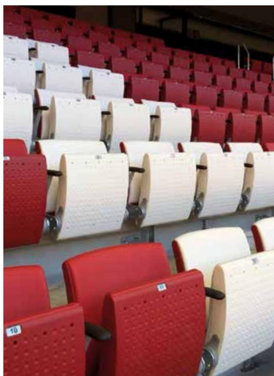
Traversenmontierter premium Klappsitz mit auswechselbaren Polstereinlegern für Sitz und Rücken. Spritzgegossene Außenschalen aus Polypropylen mit Brand- und UV-Schutzadditiven. Optional mit akustischer Perforierung für den Innenbereich erhältlich. Sitzträger aus Stahl kathodisch tauchlackiert (KTL) und pulverbeschichtet mit Epoxidharz. Lagerhebel und Drehlager aus verstärktem Polyamid mit Schlagzähmodifikatoren.
