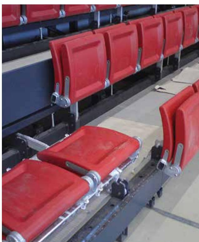
Eine gerade Rückenlehne sorgt für eine reduzierte Sitztiefe und macht dieses Modell zur idealen Lösung für einziehbare Tribünen. Traversenmontierter Klappstuhl mit ergonomisch geformter Sitzfläche und Rückenlehne aus blasgeformtem Polypropylen mit Brand- und UV-Schutzadditiven. Sitzträger und Lagerhebel aus verstärktem Polyamid mit Schlagzähmodifikatoren.
