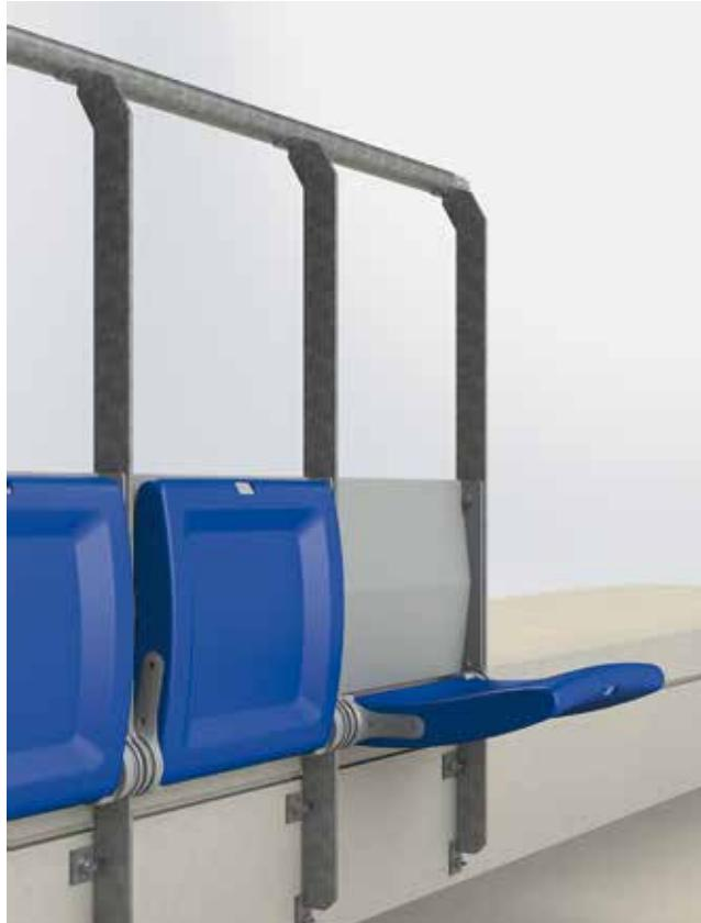
Hybrider Klappsitz im ARC-Design für sicheres Stehen und bequemes Sitzen unter begrenzten Platzverhältnissen. Die Rückenlehne, die Standsäulen und der Handlauf aus hochwertigem Stahl sorgen sowohl für Robustheit als auch für eine optimale Raumnutzung. Ergonomisch geformte Sitzfläche aus blasgeformtem Polypropylen mit Brand- und UV-Schutzadditiven. Lagerhebel und Drehlager aus verstärktem Polyamid mit Schlagzähmodifikatoren.
