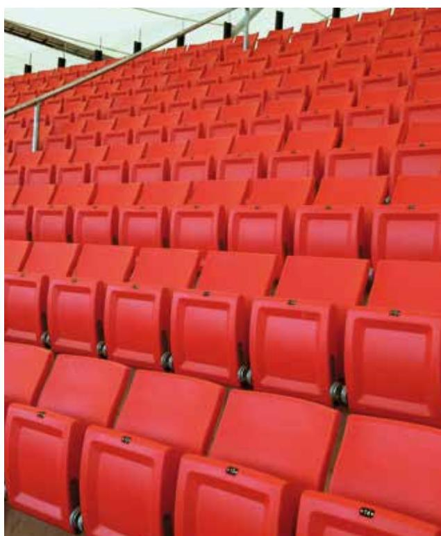
Erhöhte Rückenlehne (+100 mm) für mehr Komfort und Ästhetik. Traversenmontierter Klappsstuhl mit ergonomisch geformter Sitzfläche und Rückenlehne aus blasgeformtem Polypropylen mit Brand- und UV-Schutzadditiven. Sitzträger und Lagerhebel aus verstärktem Polyamid mit Schlagzähmodifikatoren.
