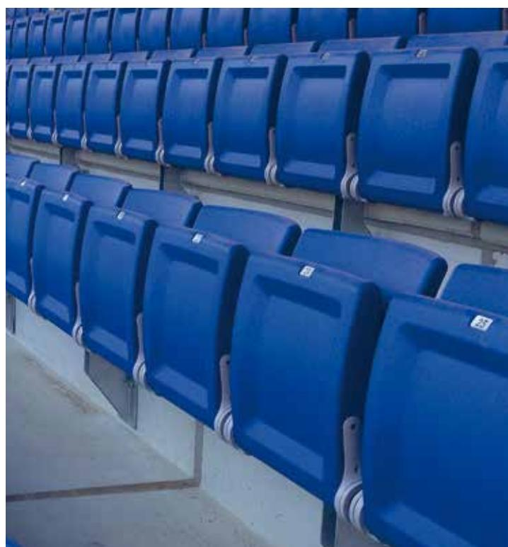
Basismodell und Bestseller der ARC-Sitzfamilie. Traversenmontierter Klapp-sitz mit ergonomisch geformter Sitz-fläche und Rückenlehne aus blasge-formtem Polypropylen mit Brand- und UV-Schutzadditiven. Sitzträger und Lagerhebel aus verstärktem Polyamid mit Schlagzähmodifikatoren.
